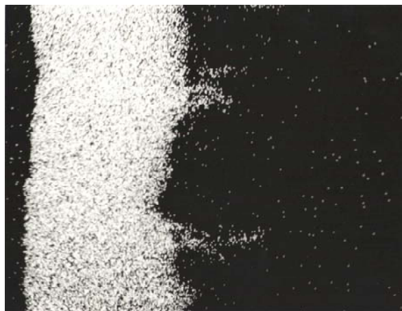
Рис. 6. Изображение поверхностного слоя в характеристических лучах ванадия
