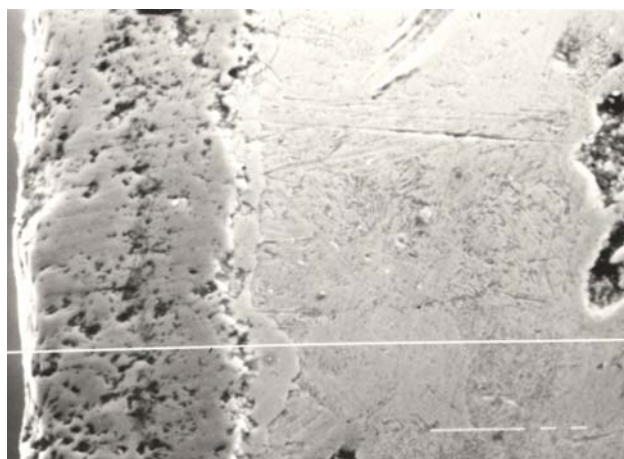
Рис. 3. Микроструктура поверхностного слоя чугуна после карбонитрации с предварительным ванадированием
