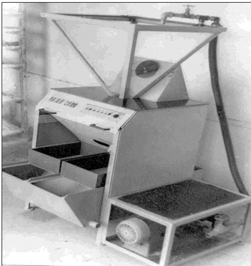
Рис. 5. Опытный образец устройства для отбраковки дефектной грены
