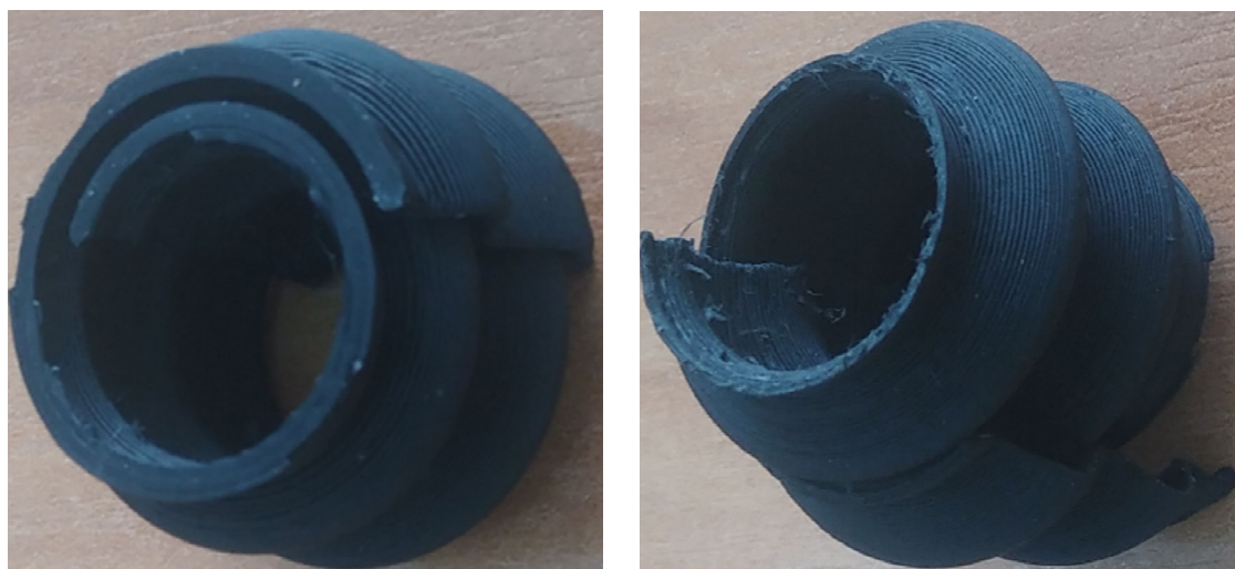
Рис. 6. Предлагаемый разъёмный гофрированный чехол
