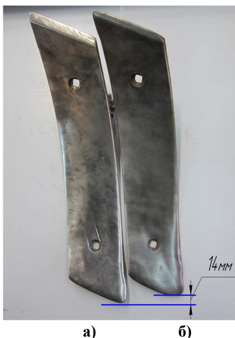
а) - экспериментальный, упрочненный с тыльной стороны; б) - серийный в состоянии поставки, достигший предельного состояния Рис. 3. Вертикальные ножи скоростного плуга ПСКУ-5 после наработки 26 га
