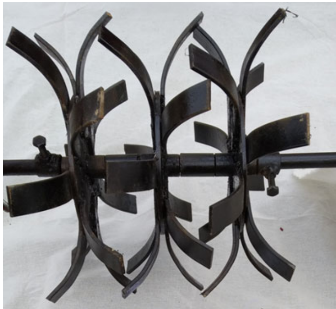
Рис. 6 - Общий вид ротационного почвообрабатывающего рабочего органа с разнонаправленными сферическими ножевыми элементами
