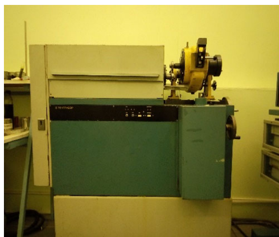
а) внешний вид ролика и колодки для испытаний; б) внешний вид машины трения ИИ 5018
