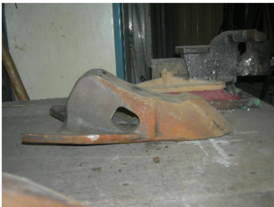
Рис. 8 - Вид на сильно изношенный анкер, который невозможно восстановить
