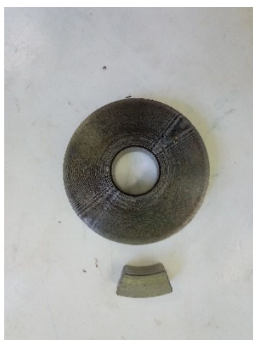
а) внешний вид ролика и колодки для испытаний; б) внешний вид машины трения ИИ 5018
