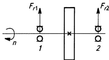
20. Определить параметры подшипника скольжения для вала мотовила комбайна «Дон-1500», если диаметр шейки вала  $d=60$  мм; частота вращения мотовила  $n=49$  мин<sup>-1</sup>; усилие, действующие на цапфу от цепной передачи привода мотовила, составляет  $F_r=4010$  Н.
