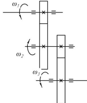
10. Рассчитать цепную передачу с роликовой цепью от асинхронного электродвигателя к приводу пластинчатого конвейера по следующим данным: мощность электродвигателя  $N = 7,5$  кВт; частота вращения  $n_1=975$  мин<sup>-1</sup> ( $\omega_1=102$  рад/с); передаточное число  $u = 3$ ; работа в две смены; нагрузка спокойная. Электродвигатель установлен на салазках, смазка цепи непрерывная (окунанием); передача расположена под углом  $40^\circ$  к горизонту.
