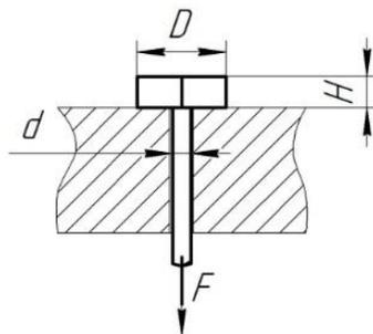
14. Проверить прочность заклепочного соединения на срез, если  $F=80$  кН;  $[\tau_c]=100$  МПа;  $[\sigma_{см}]=240$  МПа;  $d=17$  мм;  $\delta=50$  мм;  $z=3$ .  $[\tau_c]$ ,  $[\sigma_{см}]$  – допускаемые напряжения.
