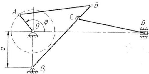
Для механизма задано положение кривошипа  $OA$  ( $\varphi=\varphi_1=45^\circ$ ) и размеры звеньев  $a=20\text{ см}$ ;  $OA=11\text{ см}$ ,  $AB=50\text{ см}$ ,  $BC=22\text{ см}$ ,  $O_1B=56\text{ см}$ ,  $CD=43\text{ см}$ . Угловую скорость кривошипа принять  $\omega_0=2\text{ рад/с}=\text{const}$ . Определить скорости всех точек ( $V_A; V_B; V_C; V_D$ ) и угловые скорости всех звеньев ( $\omega_{AB}; \omega_{CD}; \omega_{BO_1}$ ) механизма при помощи мгновенного центра скоростей (МЦС).
