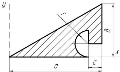
Определить координаты центра тяжести плоской фигуры из тонкой однородной пластины, если известны ее размеры  $a = 18 \text{ см}$ ,  $b = 22 \text{ см}$ ,  $c = 4 \text{ см}$  и  $r = 5 \text{ см}$ .
