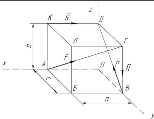
Определить главный вектор и главный момент системы сил  $F = 10 \text{ кН}$ ,  $P = 5 \text{ кН}$ ,  $R = 25 \text{ кН}$ ,  $N = 20 \text{ кН}$ , приложенных к параллелепипеду со сторонами  $a = 50 \text{ см}$ ,  $b = 50 \text{ см}$ ,  $c = 50 \text{ см}$ . Установить также к какому простейшему виду приводится данная система сил.
