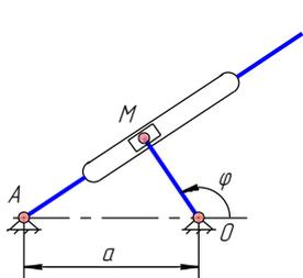
Кривошип  $OM$  вращаясь вокруг неподвижной опоры  $O$  по закону  $\varphi = 2\pi t^2$ , рад, приводит в движение ползун  $M$  по кулисе  $A$ . Определить для момента времени  $t_1 = 1/2\text{ с}$  абсолютную скорость и абсолютное ускорение точки  $M$ , если известны расстояния  $OM = 14\text{ см}$ ,  $a = 40\text{ см}$ .
