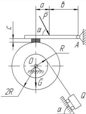
Определить, необходимые для равновесия составной конструкции, минимальное значение силы  $P$  и реакции опор  $A$  и  $O$  конструкции, нагруженной сосредоточенными силами  $Q=13\text{ кН}$ ,  $G=1,1\text{ кН}$ , если заданы расстояния  $a=0,1\text{ м}$ ,  $b=0,2\text{ м}$ ,  $c=0,03\text{ м}$  и угол  $\alpha=45^\circ$ . Коэффициент трения колодки о барабан  $f=0,25$ . Трением в опорах пренебречь. Веса нитей, стержней и колодок не учитывать.
