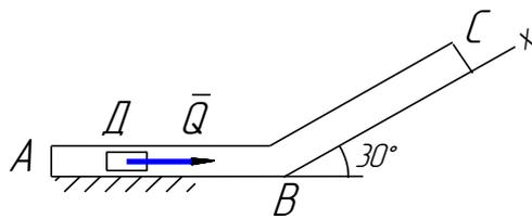
Тело  $D$  массой  $m=4$  кг движется в трубе  $ABC$ , расположенной в вертикальной плоскости. В положении  $A$  телу сообщили начальную скорость  $V_A=2$  м/с. В положении  $B$  тело, не изменяя своей скорости, переходит на участок  $BC$ . Движение тела происходит под действием сил: а) на участке  $AB$  –
