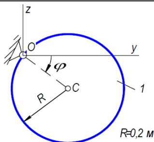
Механическая система, состоящая из однородного диска, вращается вокруг неподвижной оси. Определить реакции шарнира  $O$  в момент времени, когда угол поворота  $\varphi = \varphi_1 = 90^\circ$  если известны:  $m_1 = 40\text{ кг}$  – масса диска 1;  $\omega_0 = 1\text{ с}^{-1}$  – угловая скорость в начальный момент времени;  $\varphi_0 = 30^\circ$  – угол поворота в начальный момент времени. Толщиной диска пренебречь. Плоскость  $Oyz$  вертикальная.
