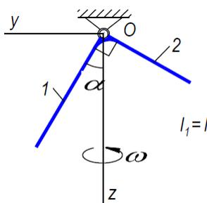
Механическая система, состоящая из однородных стержней, вращается вокруг неподвижной оси. Определить реакции шарнира  $O$  в произвольный момент времени, если известны:  $m_1 = 40\text{ кг}$  – масса стержня 1;  $m_2 = 20\text{ кг}$  – масса стержня 2;  $l = 30\text{ см}$  – длина стержня 1;  $\omega = 6\text{ с}^{-1}$  – постоянная угловая скорость;  $\alpha = 60^\circ$  – угол между стержнем 1 и вертикальной осью  $z$ . Поперечными размерами стержней пренебречь. Плоскость  $Oyz$  вертикальная.
