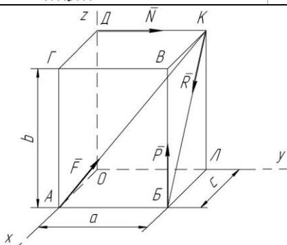
Определить главный вектор и главный момент системы сил  $F = 10\text{ кН}$ ,  $P = 5\text{ кН}$ ,  $R = 25\text{ кН}$ ,  $N = 20\text{ кН}$ , приложенных к параллелепипеду со сторонами  $a = 60\text{ см}$ ,  $b = 30\text{ см}$ ,  $c = 20\text{ см}$ . Установить также к какому простейшему виду приводится данная система сил.
