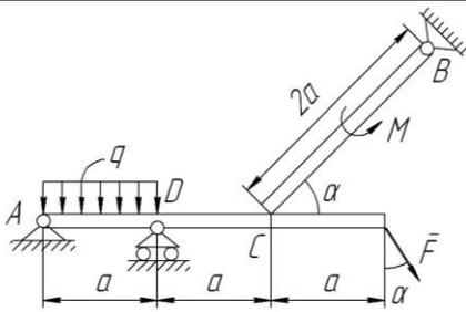
Определить реакции опор  $A$ ,  $B$ ,  $D$  и упора  $C$  составной конструкции, нагруженной сосредоточенной силой  $F=12\text{ Н}$ , моментом  $M=6\text{ Н}\cdot\text{м}$  и распределенной нагрузкой  $q=3\text{ Н/м}$ , если заданы расстояние  $a=0,2\text{ м}$ , и угол  $\alpha=60^\circ$ .
