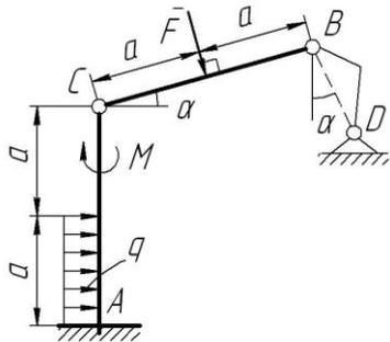
Определить реакции жесткой заделки  $A$  и невесомого стержня  $BD$  составной конструкции, нагруженной сосредоточенной силой  $F=20\text{ Н}$ , моментом  $M=10\text{ Н}\cdot\text{м}$  и распределенной нагрузкой  $q=2\text{ Н/м}$ , если заданы расстояние  $a=0,3\text{ м}$  и угол  $\alpha=45^\circ$ .
