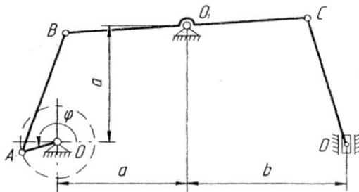
Для механизма задано положение кривошипа  $OA$  ( $\varphi=\varphi_1=60^\circ$ ) и размеры звеньев  $a=31$  см;  $b=47$  см;  $OA=10$  см,  $AB=34$  см,  $BC=64$  см,  $O_1B=32$  см,  $CD=38$  см. Угловую скорость кривошипа принять  $\omega_o=2$  рад/с = const. Определить скорости всех точек ( $V_A; V_B; V_C; V_D$ ) и угловые скорости всех звеньев ( $\omega_{AB}; \omega_{BC}; \omega_{CD}$ ) механизма при помощи плана скоростей.
