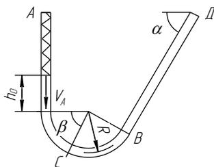
Шарик массы  $m=0,4$  кг движется внутри трубки из положения  $A$ . Заданы:  $V_A=0,2$  м/с – начальная скорость шарика;  $h_0=15$  см – начальное сжатие пружины (пройдя путь  $h_0$  шарик отделяется от пружины);  $c=0,2$  Н/см – коэффициент жесткости пружины;  $f=0,2$  – коэффициент трения скольжения шарика по стенке трубки (трением на криволинейных
