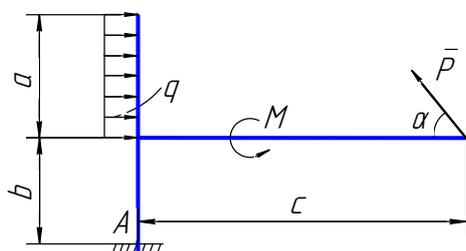
Определить реакции жесткой заделки  $A$  конструкции, нагруженной сосредоточенной силой  $P = 8\text{ Н}$ , моментом  $M = 18\text{ Н}\cdot\text{м}$  и распределенной нагрузкой  $q = 6\text{ Н/м}$ , если заданы расстояния  $a = 0,3\text{ м}$ ,  $b = 0,2\text{ м}$ ,  $c = 0,4\text{ м}$  и угол  $\alpha = 45^\circ$ .
