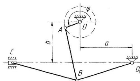
Для механизма задано положение кривошипа  $OA$  ( $\varphi=\varphi_1=75^\circ$ ) и размеры звеньев  $a=33$  см;  $b=26$  см;  $OA=10$  см,  $AB=31$  см,  $BC=40$  см,  $O_1B=37$  см. Угловую скорость кривошипа принять  $\omega_o=2$  рад/с = const. Определить ускорения всех точек ( $a_A; a_B; a_C$ ) и угловые ускорения всех звеньев ( $\varepsilon_{AB}; \varepsilon_{BC}; \varepsilon_{BO_1}$ ) механизма анали-
