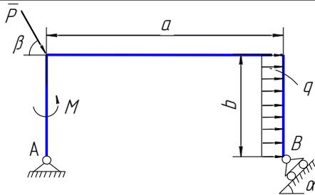
Определить реакции опор  $A$  и  $B$  конструкции, нагруженной сосредоточенной силой  $P = 12 \text{ Н}$ , моментом  $M = 6 \text{ Н}\cdot\text{м}$  и распределенной нагрузкой  $q = 3 \text{ Н/м}$ , если заданы расстояния  $a = 0,4 \text{ м}$ ,  $b = 0,2 \text{ м}$ , и углы  $\alpha = 45^\circ$ ,  $\beta = 60^\circ$ .
