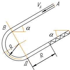
Шарик массы  $m=0,4$  кг движется внутри трубки из положения  $A$ . Заданы:  $V_A=0,5$  м/с – начальная скорость шарика;  $c=1$  Н/см – коэффициент жесткости пружины;  $f=0,2$  – коэффициент трения скольжения шарика по стенке трубки (трением на криволинейных участках трубки пренебречь);  $t_1=3$  с – время движения шарика на участке  $AB$ ;  $R=0,2$  м – радиус закругления трубки;  $\alpha=60^\circ$  – угол, определяющий
