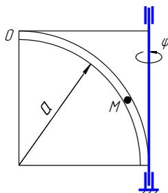
Точка  $M$  движется по трубке радиуса  $a = 20\text{ см}$  по закону  $OM = 5\pi\sqrt{2}\sin\pi/4t$ , см. Трубка вращается вокруг оси по закону  $\varphi = (3t - t^2)$ , рад, Определить для момента времени  $t_1 = 1\text{ с}$  абсолютную скорость и абсолютное ускорение точки  $M$ .
