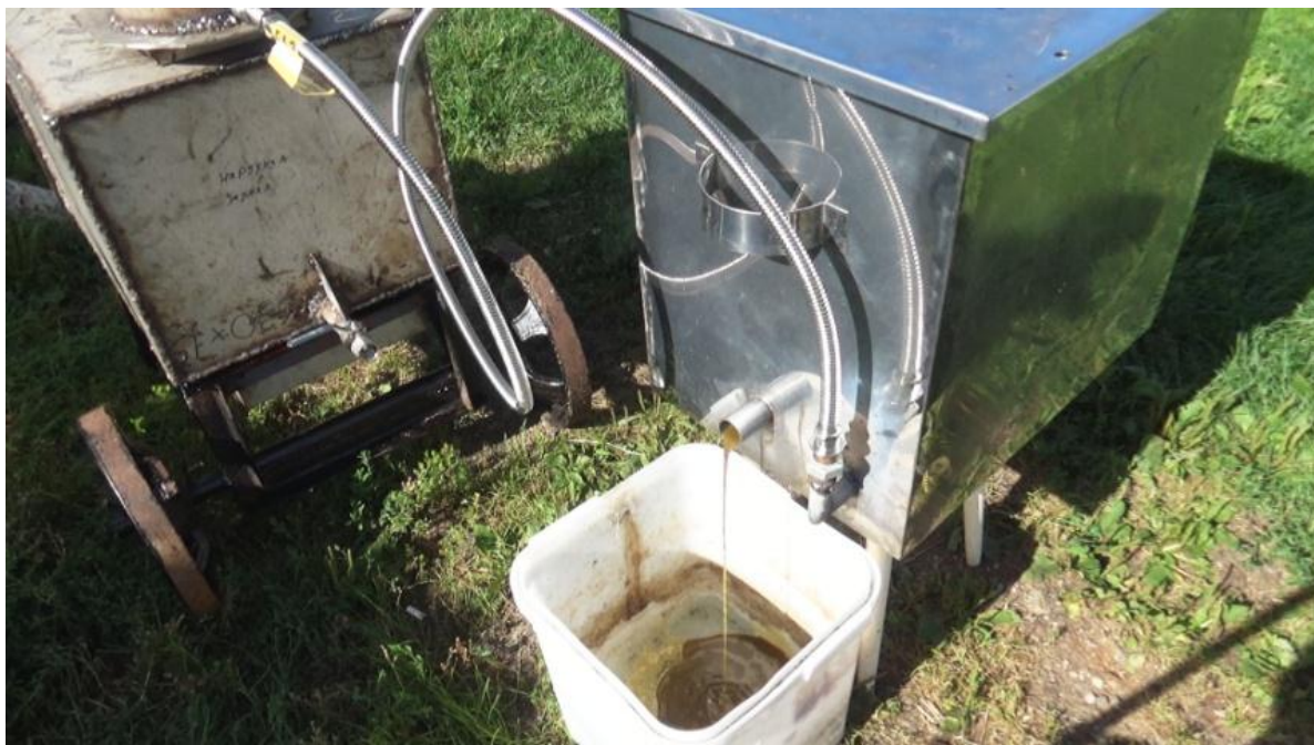
Рис. 2. Перегонка воска в рамочной воскотопке с использованием парогенератора
