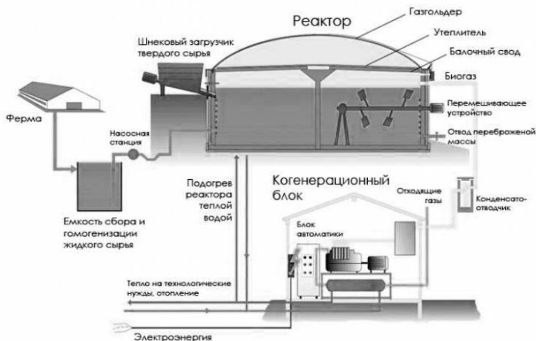
Рис. 2. Схема переработки биомассы в биогаз
