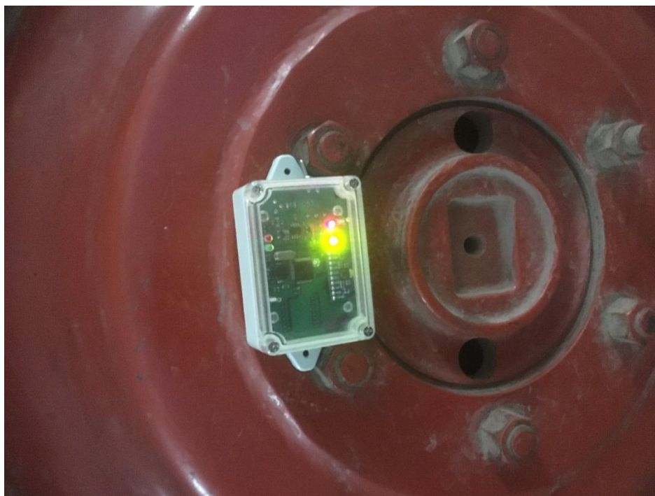
Рис. 3. Датчик ИП-291 на колесе трактора
