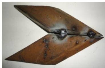
Рис. 2. Подготовленные крылья из термоупрочненных ремонтных вставок для приваривания к остову лапы.
