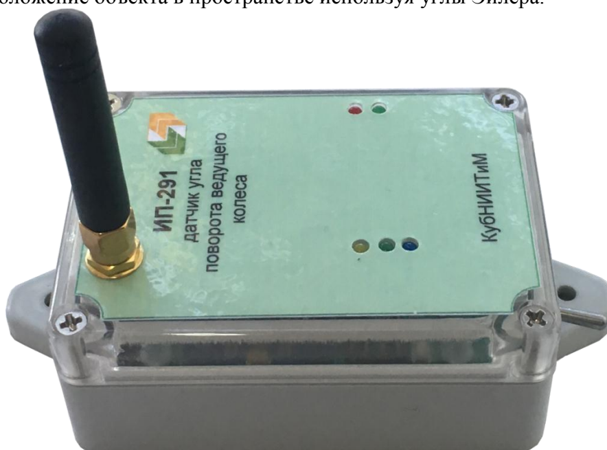
Рис. 2. Инерциальный датчик угла поворота колеса ИП-291
