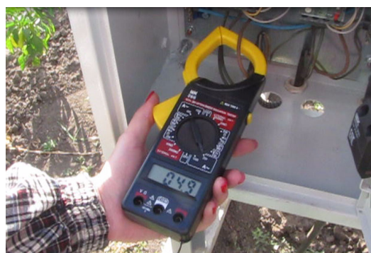
Рис. 2 – Измерение силы тока
