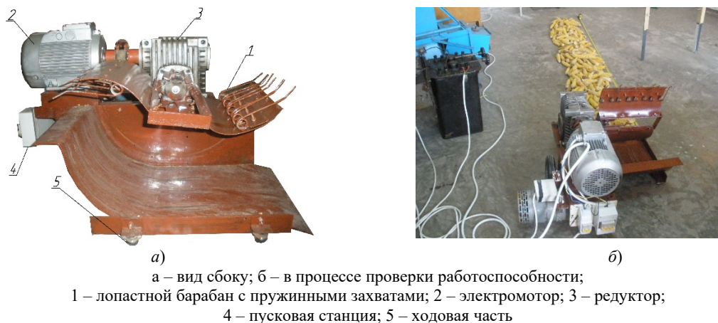
Рис. 4 – Экспериментальная модель питателя для разгрузчика хранилищ початков кукурузы
