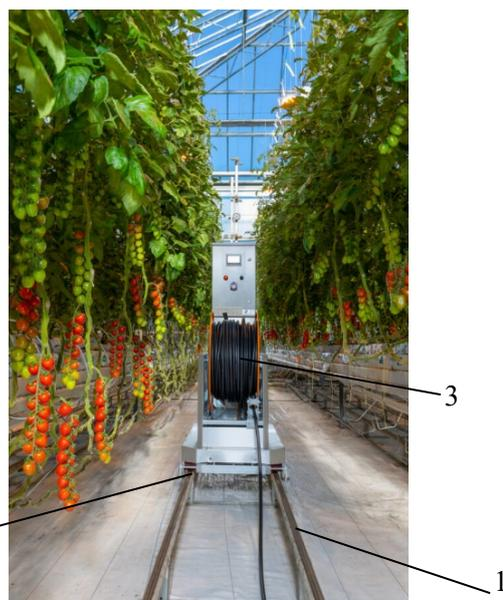
1 – рельсы технологического прохода теплицы; 2 – паз, сопрягаемый с рельсами технологического прохода; 3 – модуль технологического опрыскивателя
