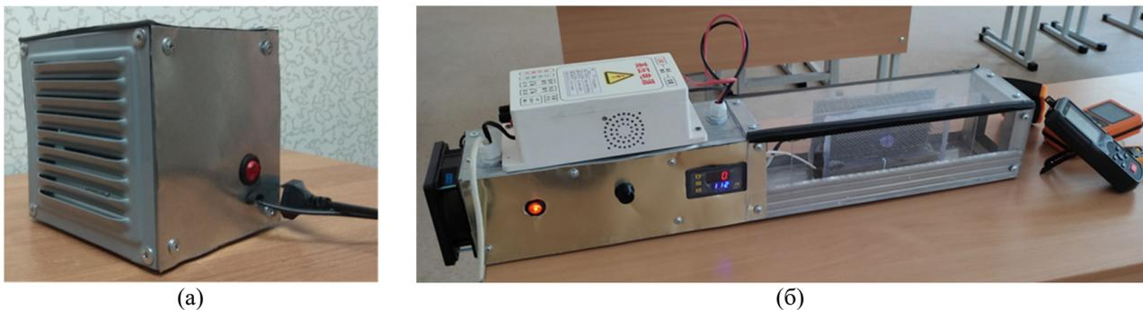
Рис. 4 – Рабочий макет и опытный образец электрического озонатора воздуха
