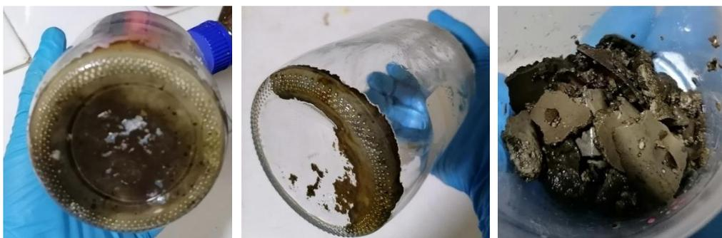
Рис. 9 – Осадок на дне реакторов в вариантах с препаратом магния гидроксида
