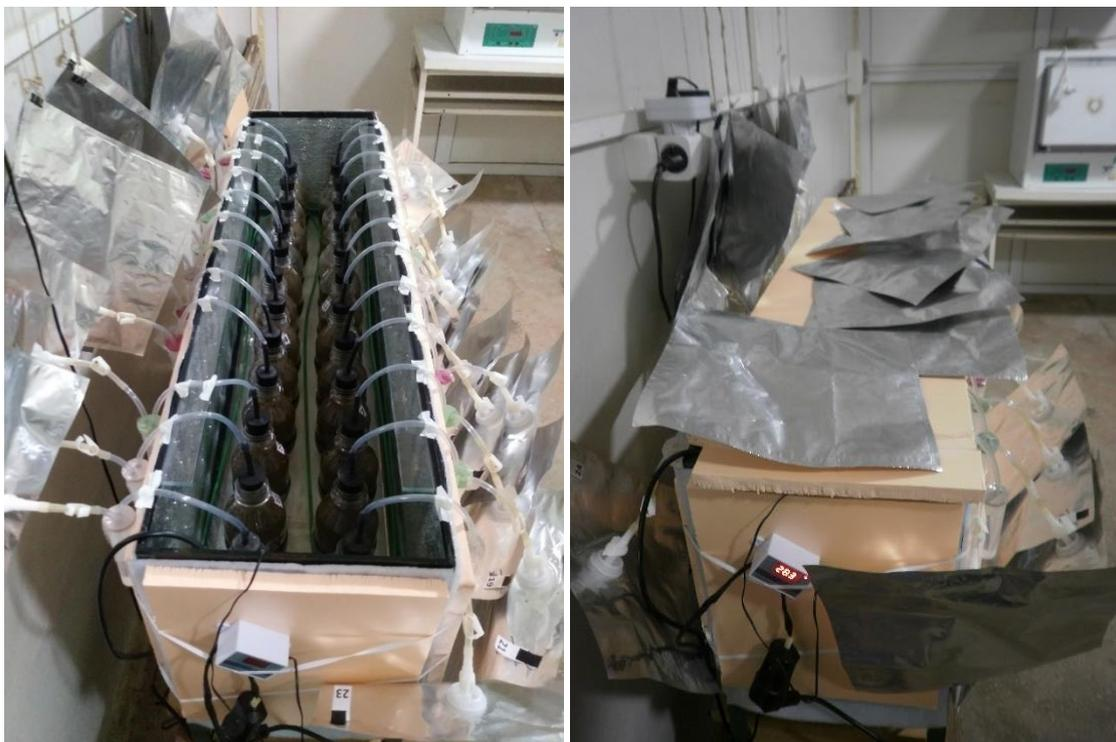
Рис. 1 – Лабораторная биогазовая установка
